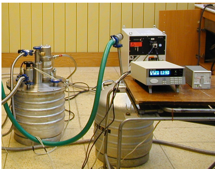
Рис. 1. Шахтный криостат замкнутого цикла на базе двухступенчатого криогенератора CoolPower 100T.
