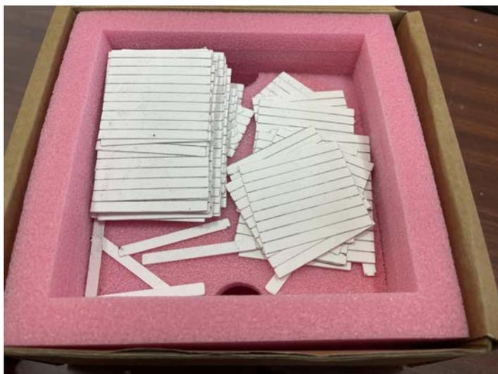
Рисунок 1.1.11.3 – внешний вид сцинтиллятора.
