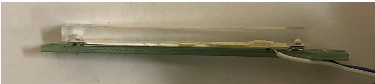
Рис. 1.1.9.1. Прототип одномерного ПЧД на основе сцинтиллятора ZnS/6LiF. Вид сбоку.
