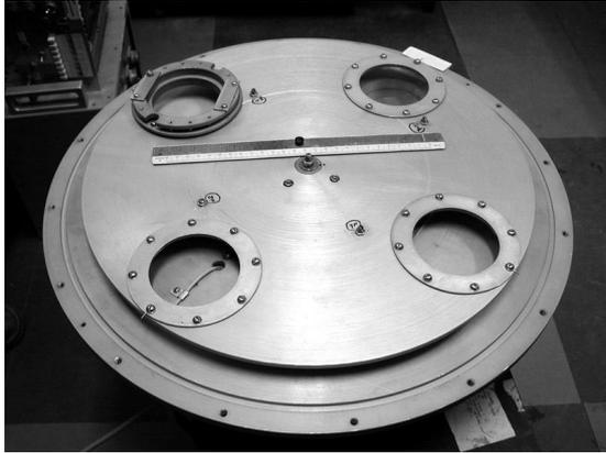
**Рис. 9.** Механизм смены образцов со снятым герметическим кожухом.
