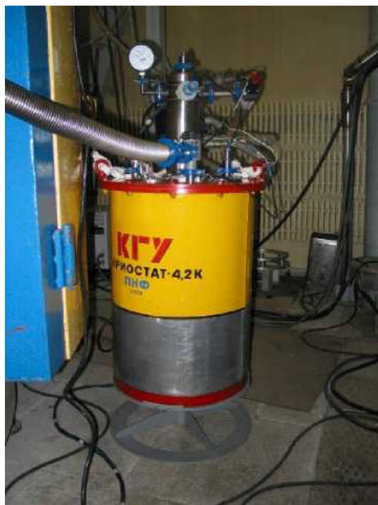
Рис.3. Криостат замкнутого цикла КГУ801 на базе двухступенчатого криогенератора RGD1245.
