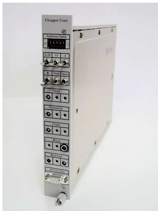
Рис.2. Контроллер управления прерывателем «Chopper Controller»
