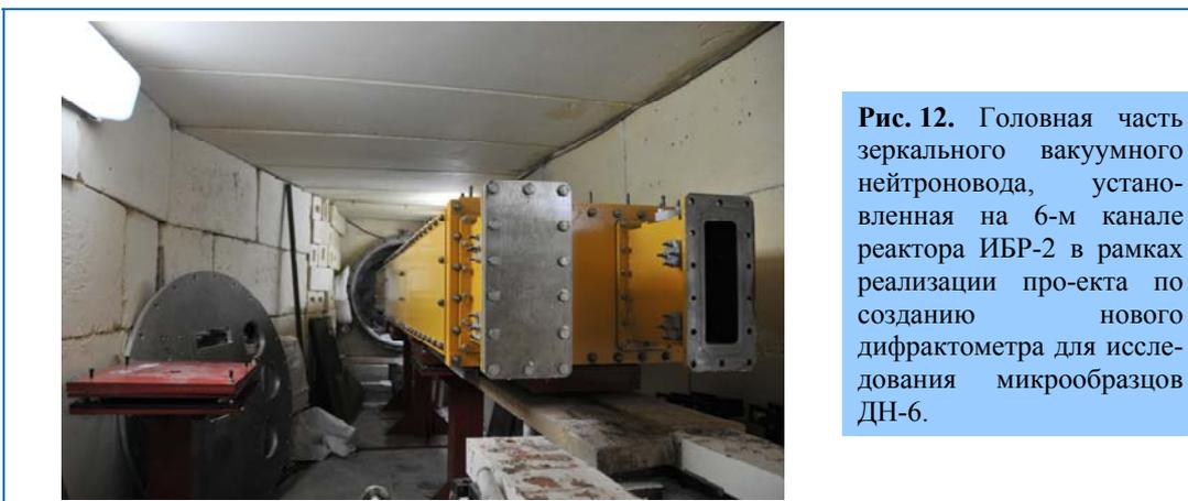
**Рис. 12.** Головная часть зеркального вакуумного нейтроновода, установленная на 6-м канале реактора ИБР-2 в рамках реализации про-екта по созданию нового дифрактометра для исследования микрообразцов ДН-6.
