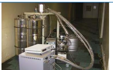
Проведено исследование возможности создания криогенной головки на пульсационной трубе в лабораторных условиях. В результате была изготовлена одноступенчатая криогенная головка, соединенная с компрессором Leybold RW4000. Конечная температура, которая достигается на этой головке, составляет 48К. Головка используется на криогенном стенде
