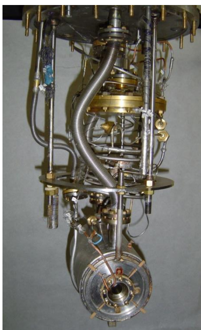
Рис. 35. Общий вид и схема узла растворения {}^3\text{He} в {}^4\text{He} : 1 – ванна испарения; 2 – теплообменник ванны испарения; 3 – непрерывный теплообменник; 4 – спеченный непрерывный теплообменник; 5 – спеченный дискретный медный теплообменник; 6 – спеченные дискретные серебряные теплообменники; 7 – ванна растворения; 8 – ферромагнитный нейтронный резонатор с поляризованной мишенью
