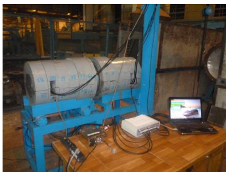
Рис. 19. 12-детекторная NaI(Tl) гамма-спектрометрическая система «Ромашка» (ИЯЯЕ-БАН) на 4-ом канале импульсного нейтронного источника ИРЕН.
