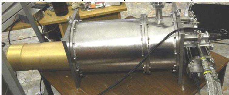
Рис. 51. Горизонтальный криостат для дифрактометра ДН-6.
