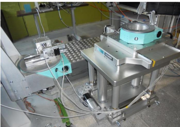
Рис. 50. Гониометр и сканер Huber на дифрактометре ФСД.
