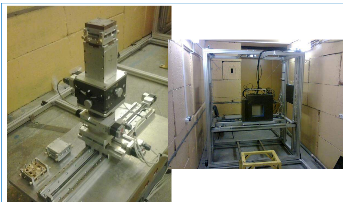
Рис. 17. Столик образца с жидкостной ячейкой (слева) и автоматическая передвижная платформа для детектора (справа).
