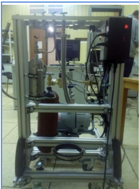
Fig. II-2-12. Mobile gas-filling unit.
