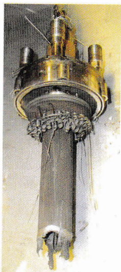
Фрагмент внутренней трубы и ТВС после эксперимента
