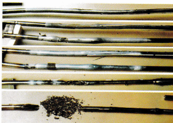
Модельные твэлы ВВЭР-1000 после испытаний
