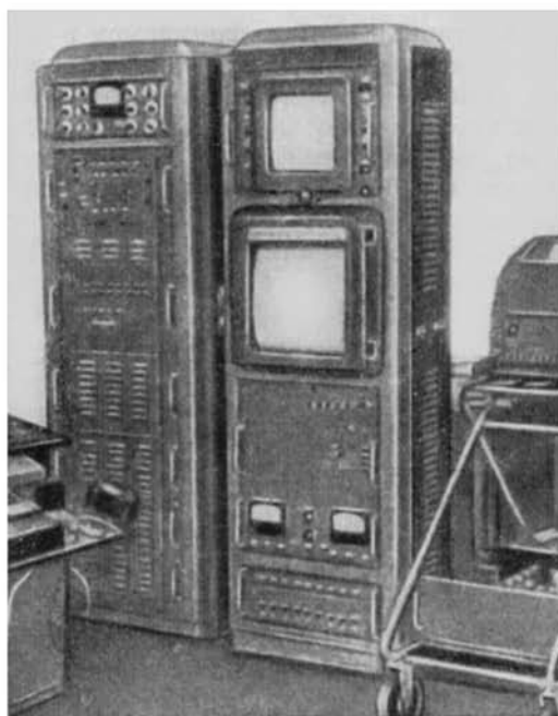
Рис. 125. Пульт управления нейтронным генератором и 50-канальный временной анализатор (а) и 100-канальный временной анализатор (б)
