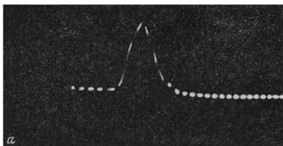
Рис. 120. Осциллограммы импульсов ионного тока (метки времени 1 мксек)
