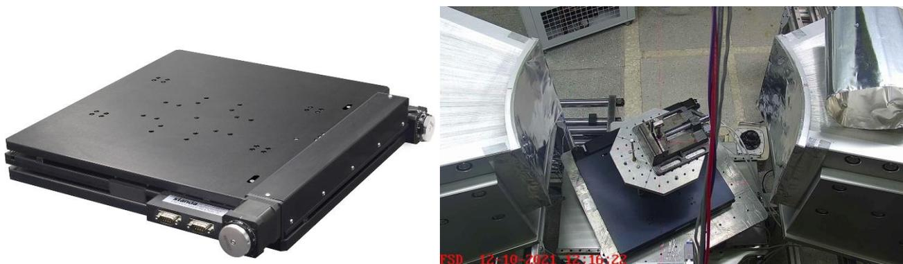
Рис. 24. а) Внешний вид платформы XY-перемещения 8MT200XY (Standa). б) Платформа XY-перемещения 8MT200XY, установленная во время эксперимента на ФСД.
